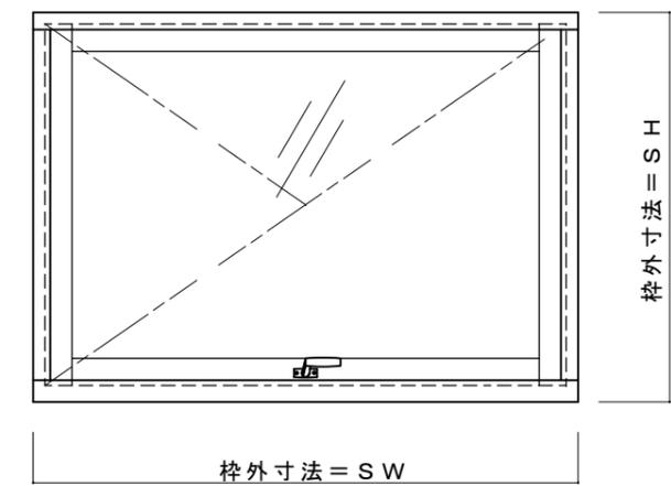
※ 障子見付・見込寸法は設置条件、外枠寸法によって変わる場合があります
